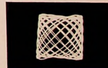
Bild 5. Lissajous-Figuren zwischen Eingangsspannung und Spannung an den verschiedenen Abgriffen. Die Unregelmäßigkeiten rühren wieder von den groben Toleranzen der Einzelteile her (vgl. Bild 3)
