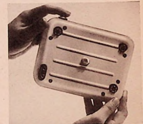
Bild 1. Zusatzkassette mit Netzteil für einen Batterie-Empfänger
